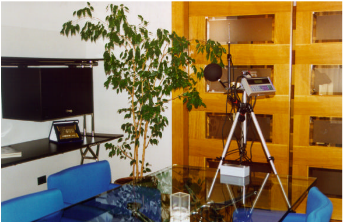
Figura 2 Multiacquisitore Babuc per la misura dei principali indici microclimatici e della concentrazione dei gas negli ambienti di lavoro
